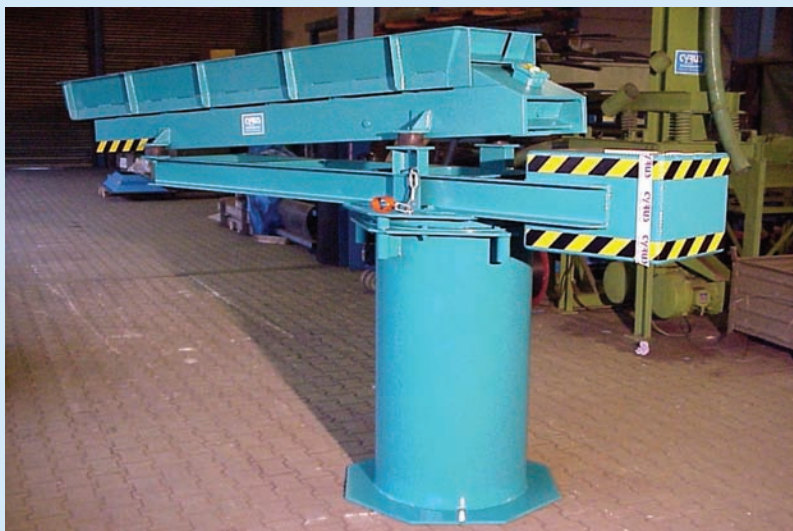
Magnetschwingrinne 400/450 x 3.000 mm, 10 t/h
