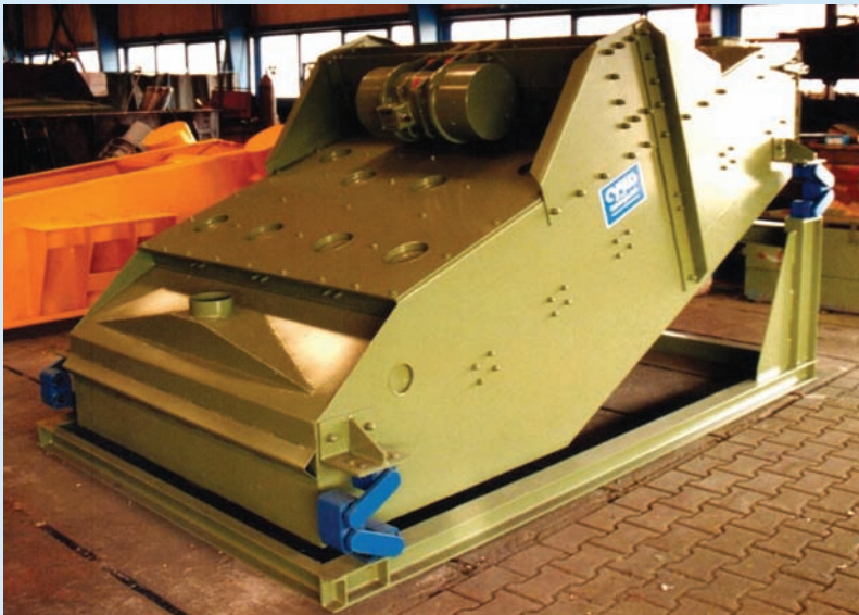
Staubgeschützte Ausführung, Futtermittel/Zement
