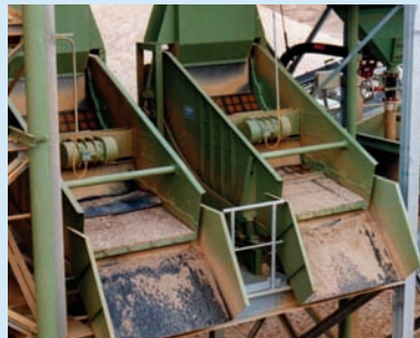
Entwässern 200 m 3 , 1.500 x 3.600 mm, Steine/Erden
