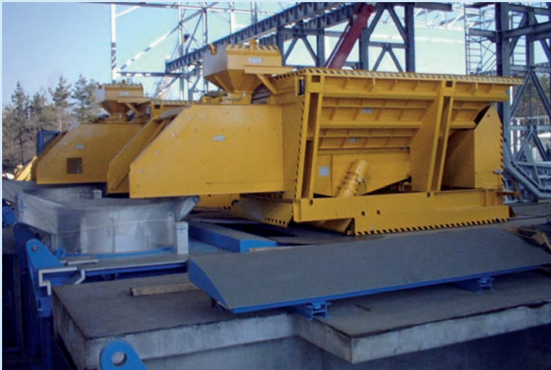
Chargiermaschine 16 m 3 mit Zuschlagstoffbehälter 1 m 3
