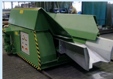
Chargiermaschine Kompaktbauform, 3 t Bunkervolumen, Gesamthöhe 1.250/1.500 mm
