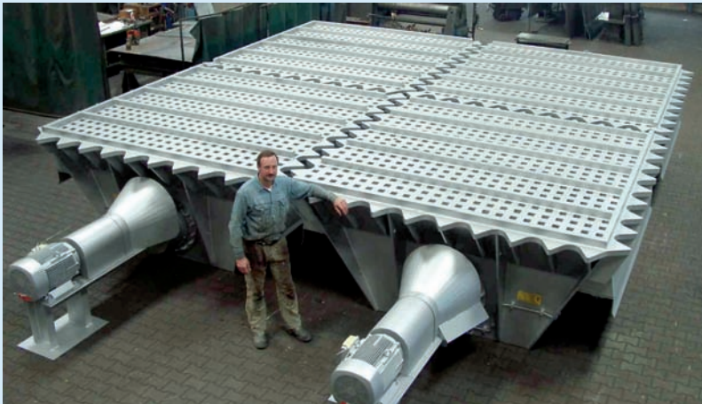
Ausschlagrost 6.300 x 6.300 mm, Auflast 40 t (Einzelaufplast bis 15 t/Rost)
